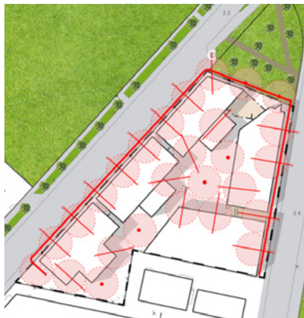
Kuva 19. Maalämpöjärjestelmän osien sijoittaminen Vattuniemen korttelissa 31114.
